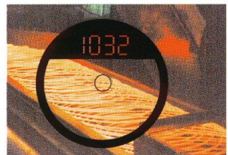
ファインダー内温度表示 ○印内測定スポット
