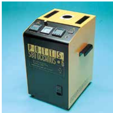
挿入深さ 250 mm 標準均熱ブロック（φ 50 mm × 長さ 300 mm）
