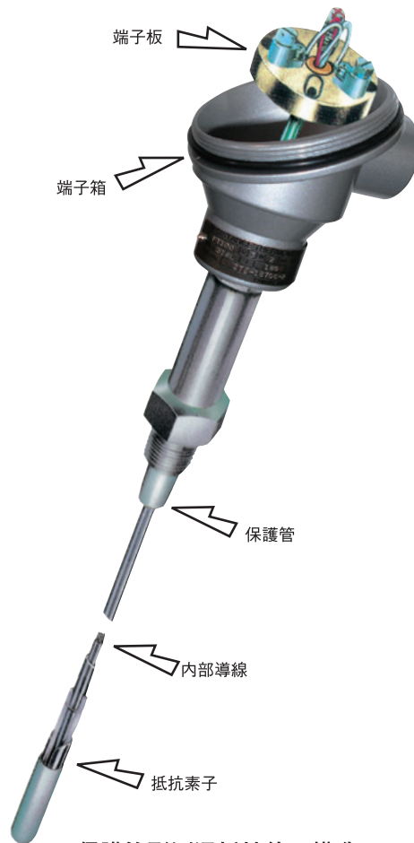
保護管形測温抵抗体の構造
