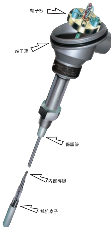
保護管形測温抵抗体の構造
