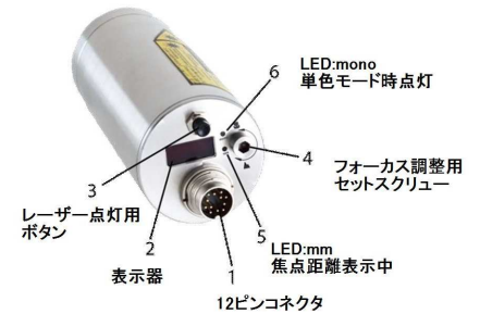
リアパネル例 (レーザーパイロットライト)
