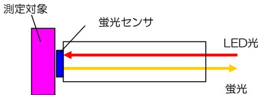
◆赤色LED光によって発生した光をファイバーで導き、プローブ先端にある蛍光センサに吸収させます。
